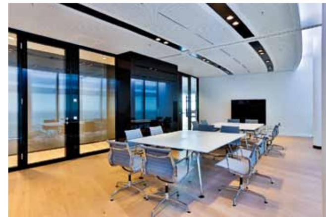
In der 18. Etage setzen schwarz verklebte Structural Glazing Wände mit flächenbündigen 100 mm Türen ein gestalterisches Highlight.
