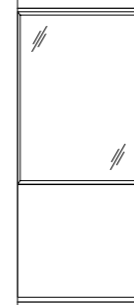
ALURAHMENTÜR mit Oberlicht und Türseitenteil
